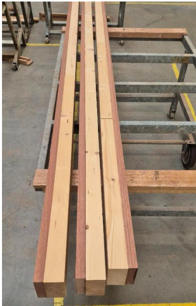
Persen dagkant en zichtkanten op sloophout
